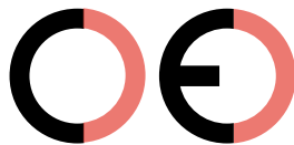
Falsche CE-Kennzeichnung (zu großer Zwischenraum)
